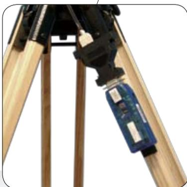
Il dispositivo, trasmettendo ad una frequenza ( 2,4 GHz) ben lontana dalla banda di funzionamento di EHP 50 ed EHP 200, non ne compromette la funzionalità, inoltre è posizionato ad una distanza superiore a quella indicata da Narda per il corretto funzionamento della sonda tenendo conto dell'incertezza introdotta dalle circuiterie del trasmettitore stesso.
