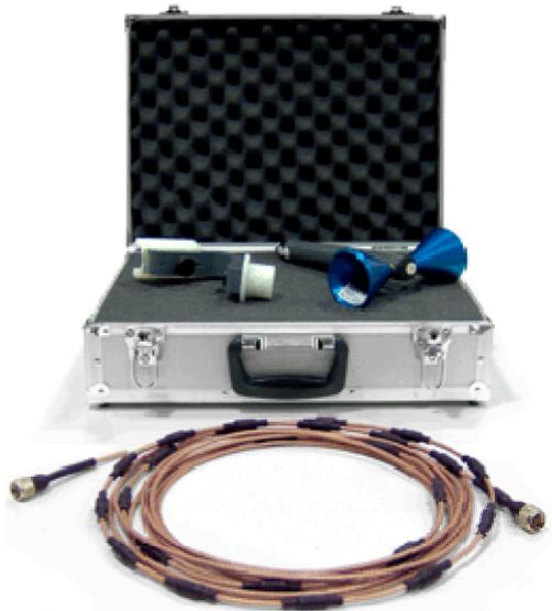
AP2000 è un'antenna biconica che permette di eseguire misure di esposizione ambientale (elettromog) alle radio frequenze in prossimità di stazioni radio televisive e ripetitori per la telefonia mobile Tetra, GSM, UMTS.
