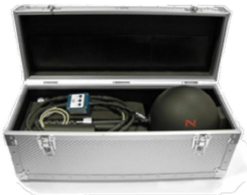
AT3000 è una sonda isotropica evoluzione delle soluzioni monoassiali della famiglia AP (**AP1000**, **AP2000**, **AP3000**, **AP6000**) che permette di eseguire misure di esposizione ambientale (elettrosmog) alle radio frequenze in prossimità di stazioni radio televisive e ripetitori per la telefonia mobile Tetra, GSM, UMTS, Wi-Fi (802.11 b/g 2400 MHz), Wi-Max (2500 MHz), LTE.
