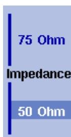
La maggior parte delle applicazioni a RF usano impedenze di 50  $\Omega$ ; altre applicazioni, come la TV via cavo utilizzano 75  $\Omega$ . Il 9101 è progettato con un'impedenza di 50  $\Omega$ ; però può essere usato per verificare dispositivi con impedenza di 75  $\Omega$  usando l'interruttore di impedenza. I risultati delle misure effettuati a 75  $\Omega$  vengono ricalcolati per tenere in conto la diversa impedenza.
