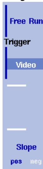
Il 9101 può iniziare le misure o in un istante casuale oppure quando una soglia assegnata sul segnale viene superata. L'inizio delle misure sulla base del livello del segnale è una caratteristica supportata solo nella modalità zero span.
