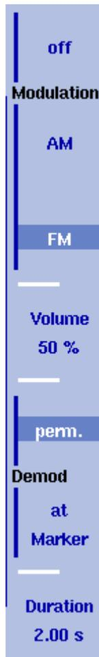
Il 9101 è in grado di demodulare segnali modulati AM (modulazione di ampiezza) o FM (modulazione di frequenza) e di inviare il segnale d'uscita all'altoparlante interno. Il segnale deve avere una potenza pari almeno a  $-50$  dBm; la banda di demodulazione è circa pari a 10 kHz.
