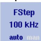
Le frequenze centrale, iniziale e finale possono essere impostate sia digitando un nuovo valore con i tasti numerici, che utilizzando i tasti freccia (**Su, Giù**) per aumentare o diminuire l'impostazione corrente. La dimensione del passo per una pressione del tasto freccia può essere selezionata automaticamente dal 9101 o regolata manualmente.
