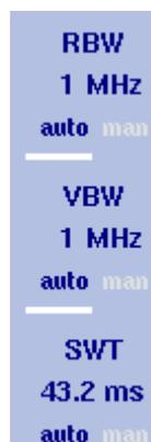
Il filtro di risoluzione di banda (resolution bandwidth RBW) è la banda a 3 dB del filtro IF utilizzato per selezionare il segnale da misurare. Il filtro di risoluzione di banda specifica la capacità dell'analizzatore di spettro di distinguere due segnali adiacenti di ampiezza simile. Solo segnali spazati più della RBW possono essere distinti l'uno dall'altro.
